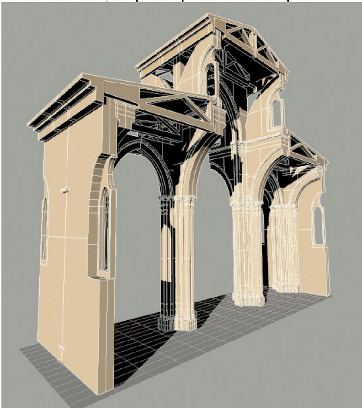
Elemento de nave sin bóvedas , para la observación de cerchado de cubiertas .
