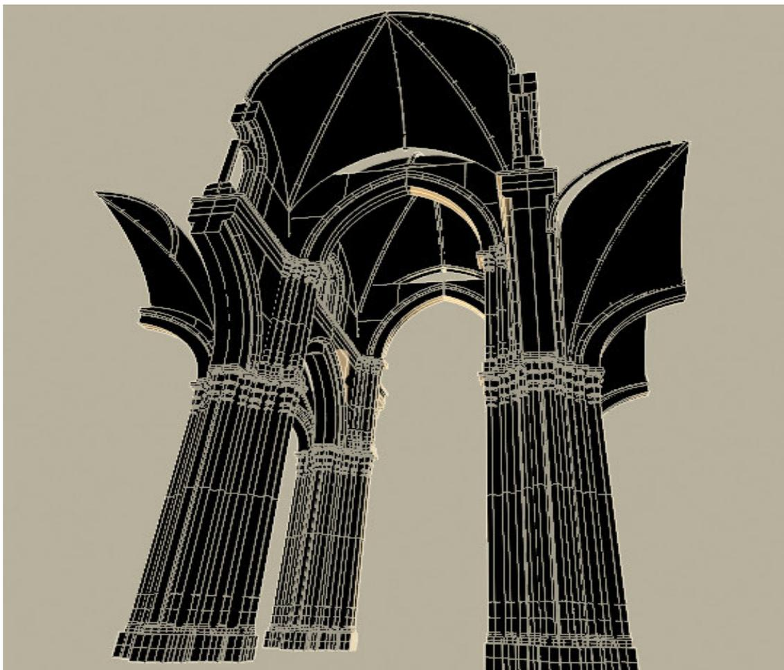
Las bóvedas , formadas por triángulos esféricos ( 8 ) , se corresponde a la representada en la siguiente lámina , que también muestra su construcción . Tiene nervios en los encuentros de estos triángulos esféricos . Entre bóvedas , lleva unos fuertes arcos facones , que descansan en 6 columnas , prolongaciones de las de las pilastras . por el lado de la nave mayor , no existiendo en las laterales de menos altura .
