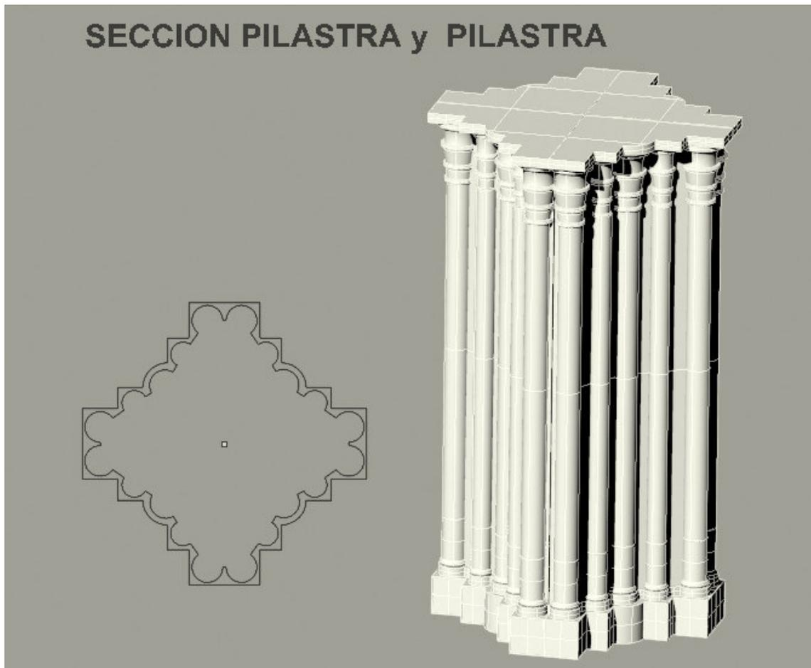
**La sección de la pilastra , tiene forma de cruz y tiene adosadas 20 columnas . Estas pilastras están repetidas en todo el tramo de la nave central .**
