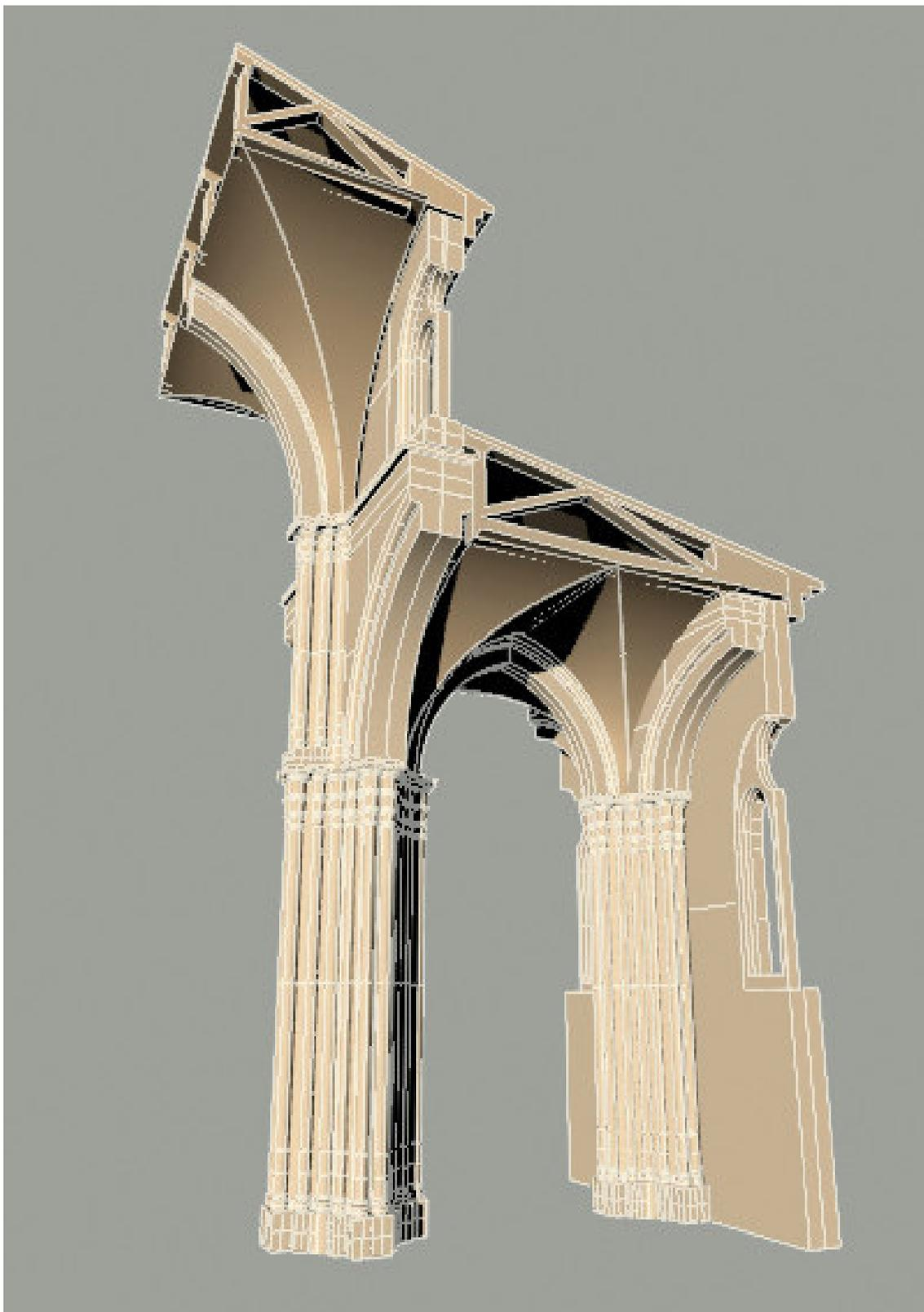
**Medio elemento de nave . Obsérvense las pilastras continuadas en la nave central , para descanso de nervios de bóvedas . Se han incorporado las Bóvedas .**
