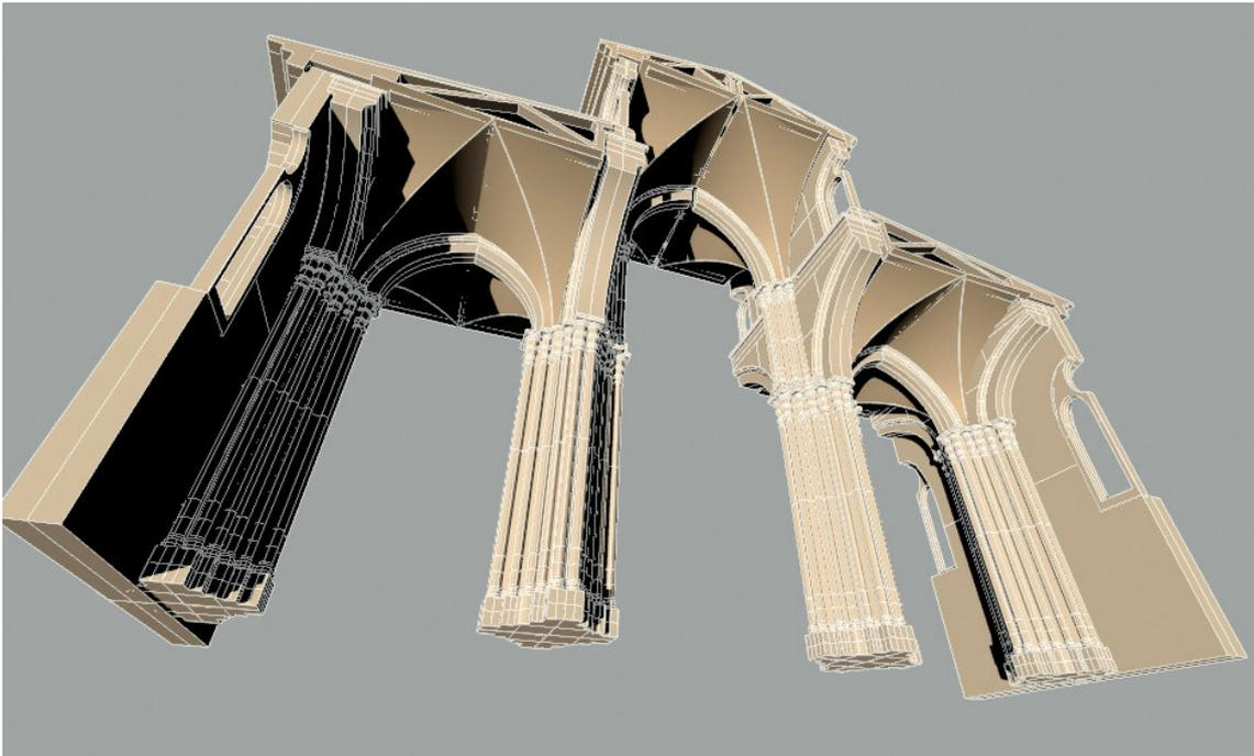
En la imagen , puede verse un elemento de nave , donde claramente se recogen las pilastras , arcos fajones y bóvedas , de las tres naves . La central más alta e iluminada con ventanales y las dos laterales más bajas .
