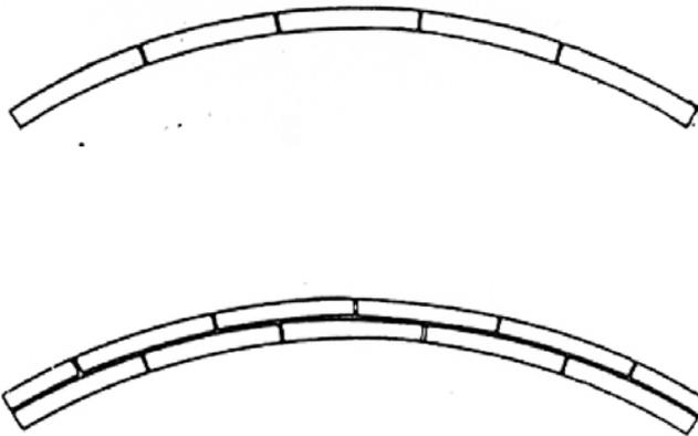
Figura 9. Arco mecánico, las piezas de fábrica actúan como dovelas.
